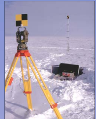
Temperaturmast der HfT-Stuttgart mit 6 Messstellen bis 3 Meter über Grund, Theodolit mit Zieltafel zur gegenseitigen Zenitwinkelbeobachtung
